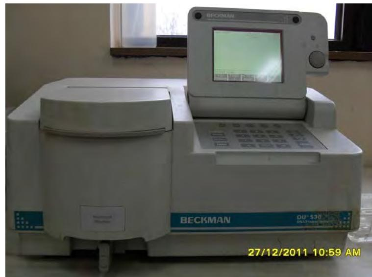
**Slika 3.4.** Spektrofotometar Beckman D® 530, DNA/Protein A
