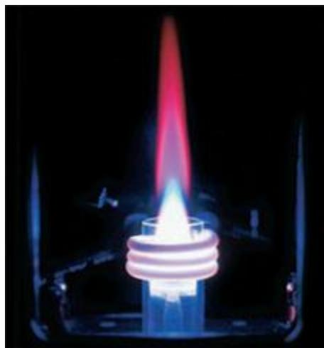
*Slika 3.8.3: Izgled induktivno spregnute plazme*
