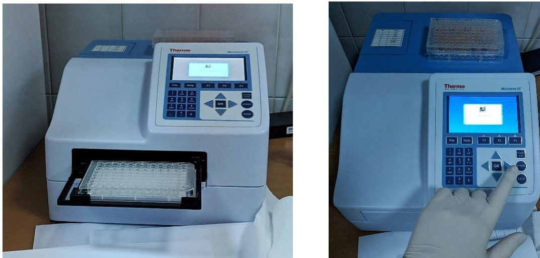
Слика 13. ELISA читач (Multiscan™ FC Microplate Reader, Thermo Scientific)
