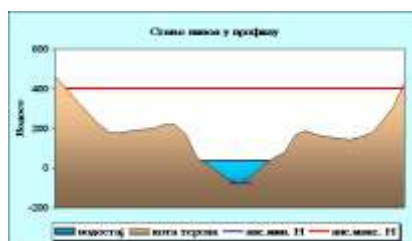
Слика 4.5.2.1- Облик попречног профила реке Јасенице код хидролошке станице Смедеревска Паланка (Извор: РХМЗ)
