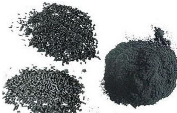
Slika 2.1. Izgled tipičnog granulisanog i praškastog aktivnog uglja
