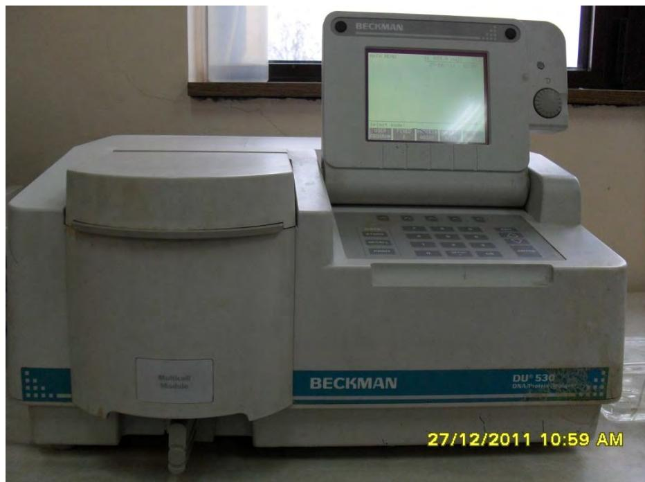
**Slika 3.5.** Spektrofotometar Beckman D<sup>®</sup> 530, DNA/Protein Analyzer
