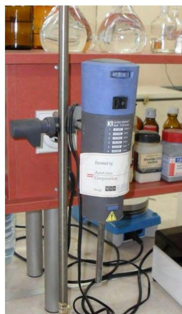
**Slika 3.4.** Homogenizator K Ultra Turrax<sup>®</sup> IKA<sup>®</sup> T18 basic
