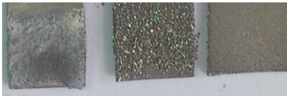
**Slika 4.9.** Površine prevlaka dobijenih potenciostatskom katodnom elektrodepozicijom iz kiselog rastvora Bi(III) na (s leva na desno): 0,1, 0,3 i 0,6 V.
