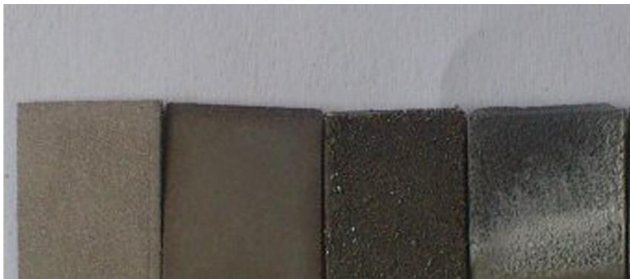
**Slika 4.6.** Površine prevlaka dobijenih galvanostatskom katodnom elektrodepozicijom iz kiselog rastvora Bi(III) pri (s leva na desno):  $10, 30, 50$  i  $100 \text{ mA cm}^{-2}$ .
