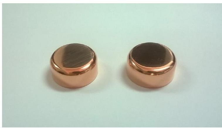
Slika 2.4. Fotografija korišćenih elektroda od bakra.
